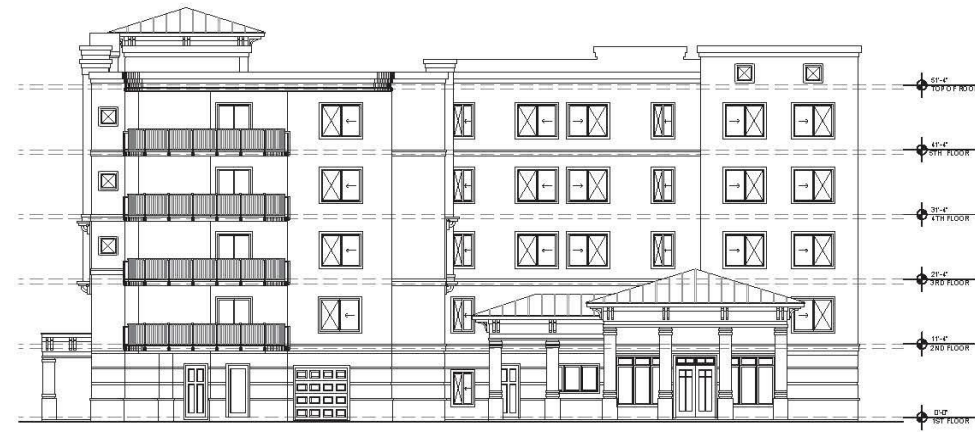
2 EAST ELEVATION SCALE: 1/8" = 1'-0"
